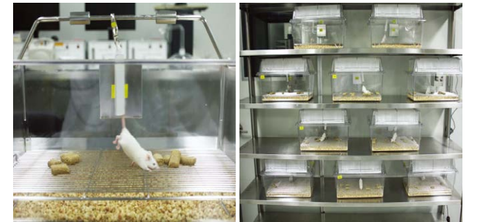
그림 2 실험동물의 꼬리를 매달아, 뒷다리를 땅에 닿지 않게 하고, 앞다리만 땅에 닿게 하는 '하지현수기법(hindlimb unloading)'을 이용한 미세중력 연구장비.
