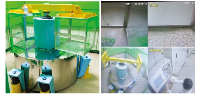
그림 1 실험동물이 들어 있는 사육용 케이지를 고속으로 회전시켜, 실험동물을 고중력에 노출시킬 수 있는 고중력 연구장비.
