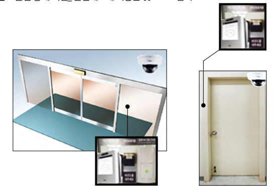
그림 1 출입 통제 시설_출입개소에 자동문 및 CCTV 설치
